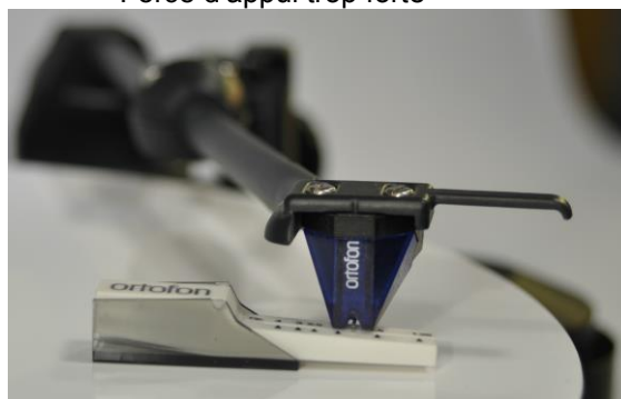
Force d'appui trop forte
